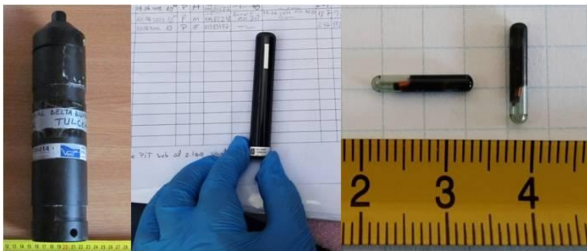
Figura 1: Receptor acustic VR2W (stânga), marcă V16P (mijloc) folosită la marcarea adulților de sturioni, marcă PIT (dreapta)
